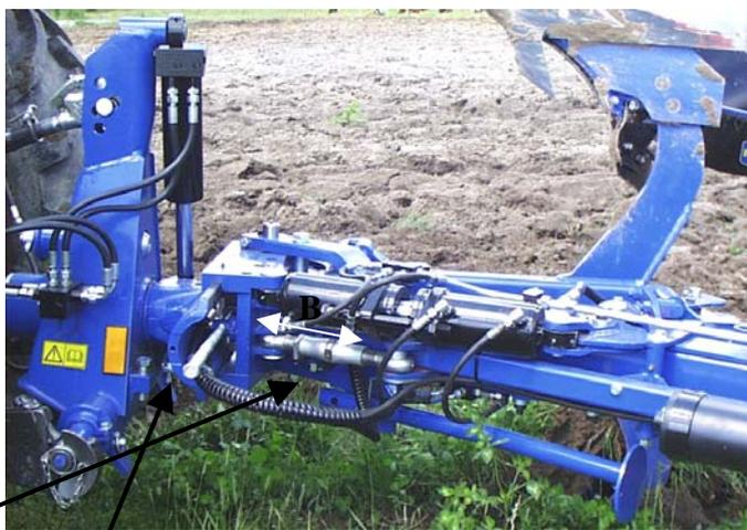
**B**- tensor      **A** Tornillo de ajuste del primer surco
