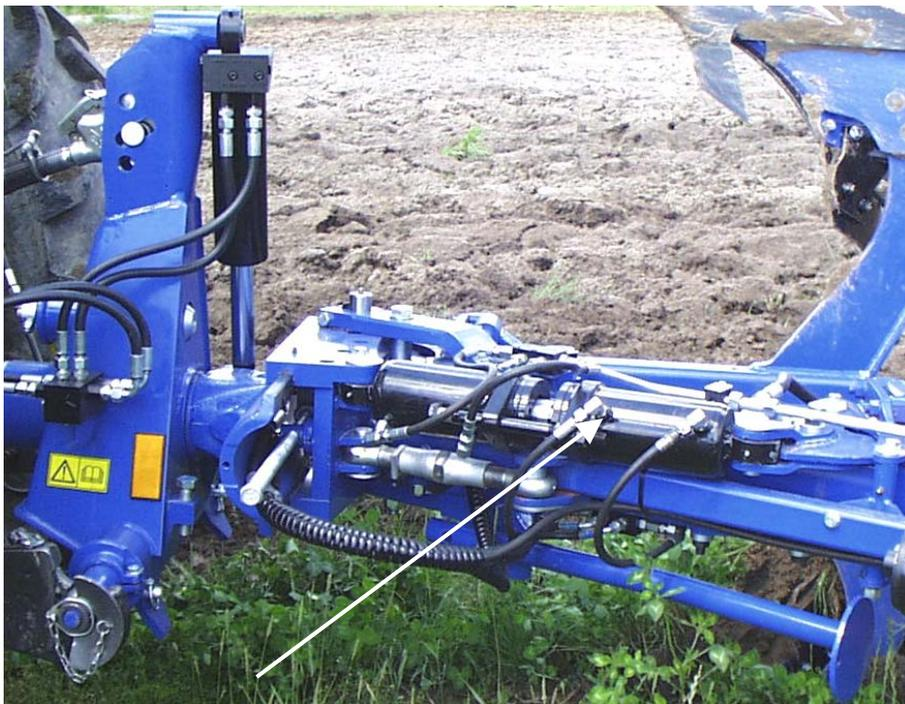
Cilindro hidráulico para variar el ancho de labor
