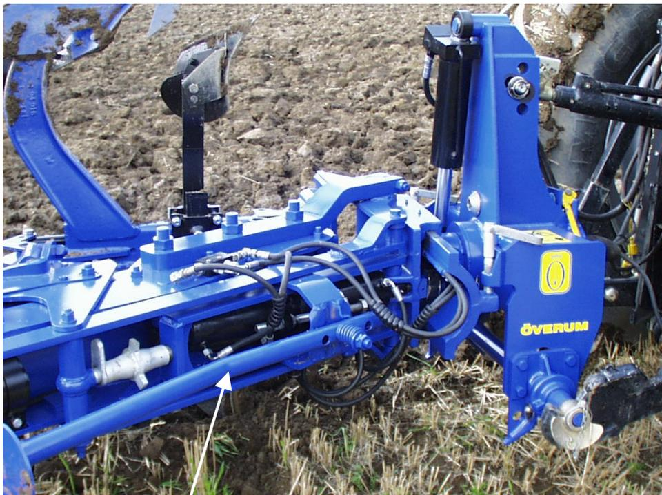
Cilindro hidráulico para variar el ancho de labor
