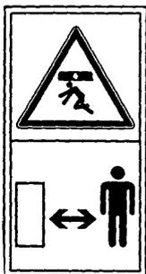
*Nunca trabaje debajo del arado levantado sin asegurarlo firmemente con un pie o pata de seguridad, para evitar que se baje accidentalmente. Nunca confíe únicamente en el elevador hidráulico del tractor.*
