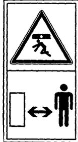
§ Manténgase zona de volteo, cuando se desbloquee el cabezal de la posición de transporte.
