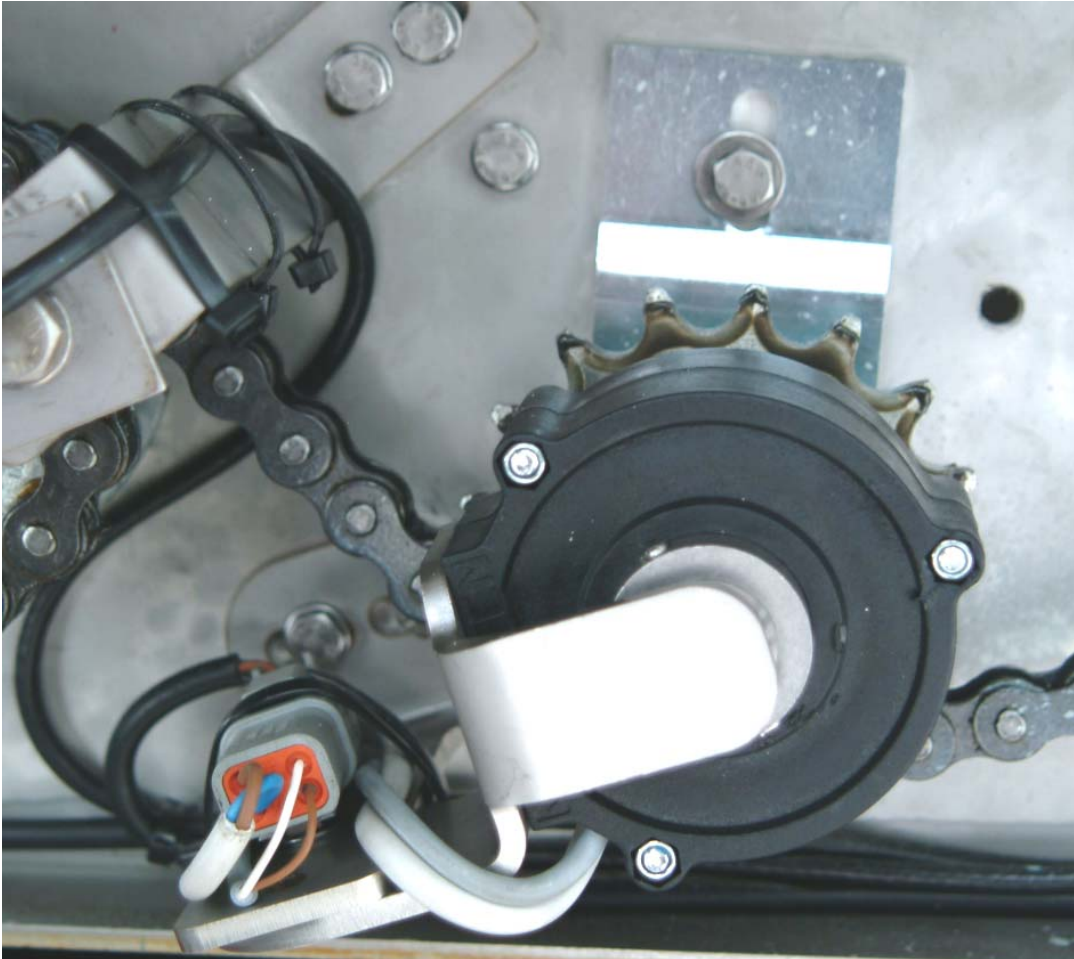
Elektriskt manövrerad matarvalskoppling för delavstängning, styrd från manöverboxen i traktorn.
