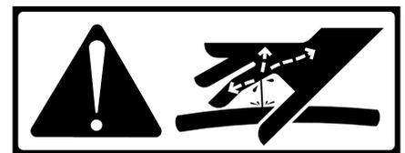
Les flexibles hydrauliques ne doivent être branchés aux prises du tracteur que si le tracteur et la machine ne sont pas sous pression. Si l'hydraulique du tracteur est actionnée, cela peut entraîner des mouvements incontrôlés qui peuvent causer des dommages.
