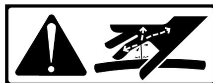
S'assurer que personne ne soit à proximité de la machine lors de la mise en route, car de l'air resté dans le circuit hydraulique pourrait entraîner des mouvements intempestifs de la machine.
