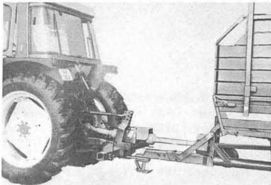
Para el desacoplamiento abrir el dispositivo de bloqueo con la cuerda, bajar la torreta de acoplamiento hasta que las patas de apoyo del remolque estén firmes sobre el suelo.
