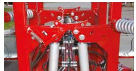
Sistema automático de bloqueo hidráulico de las secciones.
