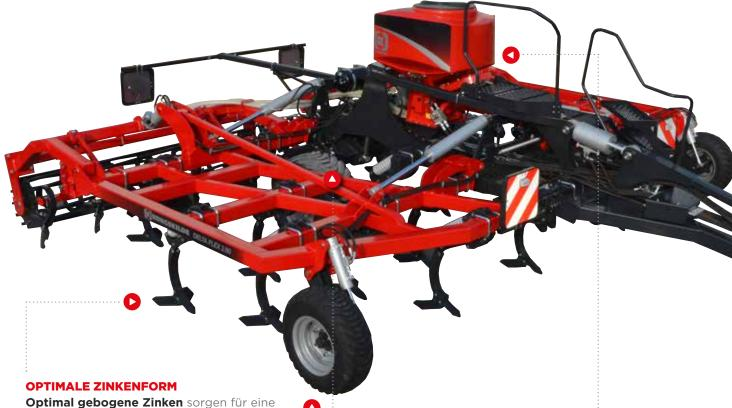
**Optimal gebogene Zinken** sorgen für eine sehr gute Durchmischung des Bodens und beste Einarbeitung von organischer Masse. Der Scharwinkel sorgt für einen guten Einzug in den Boden und wenig Zugkraftbedarf.
