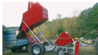
Tanken har en aflæsningshøjde på 2,3 m.
