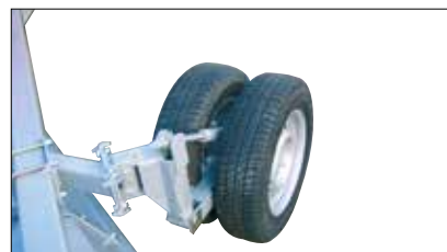
På SB 5200 styres stenrivers arbejdsdybde af indstillelige tvillinghjul.
