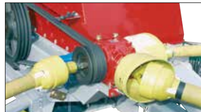
Løftetromlen drives via en gearkasse og et kileremstræk.
