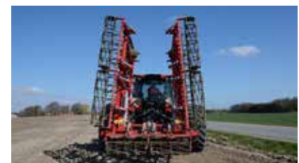
Rabatire pe vertical pentru o latime de transport de 3,0 m
