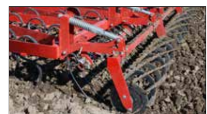
Sistemul de atasare al grapei posterioare ofera posibilitatea alegerii presiunii tavalugilor si a unghiului de atac
