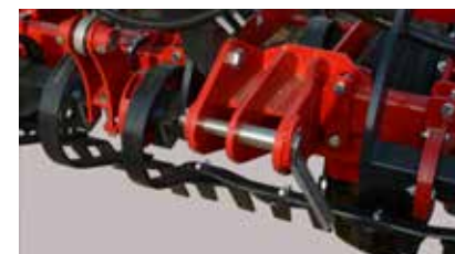
Sistem de atasare cat.2 si 3. Bolturile de prindere sunt protejate impotriva torsiunii.
