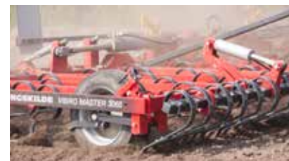
Bara nivelatoare hidraulica ce asigura spargerea bolovanilor si nivelarea inainte de inceperea cultivarii
