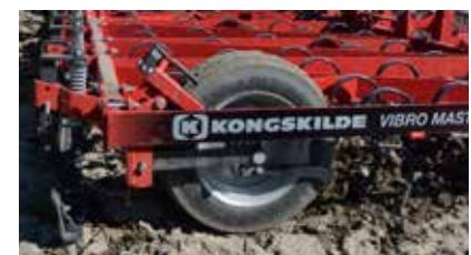
4 roti din cauciuc in tandem pentru a asigura o copieie unorma a solului
