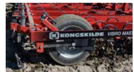
4 große Gummiräder, die im vorderen Bereich des Vibro Master auf festem Boden laufen, sorgen für eine gute Tiefenführung.
