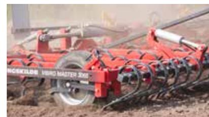
Einebner, mit oder ohne Zinken, für Zerkleinerung und Einebnung bevor der Boden die Federzinken erreicht.
