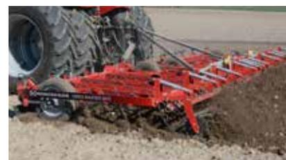
5 symmetrisch angeordnete Zinkenreihen gewährleisten einen freien Durchfluss von Boden und Ernterückständen
