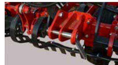
Unterlenker- Anbau Kat. 2 & 3. Die Bolzen sind gegen Verdrehen und Verschleiß gesichert.
