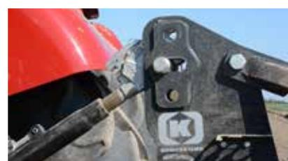
Das Langloch für den Oberlenker gewährleistet eine gute Boden-anpassung, auch bei welligem Gelände. Dadurch wird der Rahmen des Vibro Master vor Überlastung geschützt.
