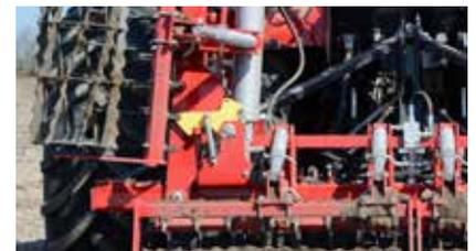
Hydraulisches oder mechanisches Verriegelungssystem, das bequem von der Schlepperkabine aus bedient werden kann.
