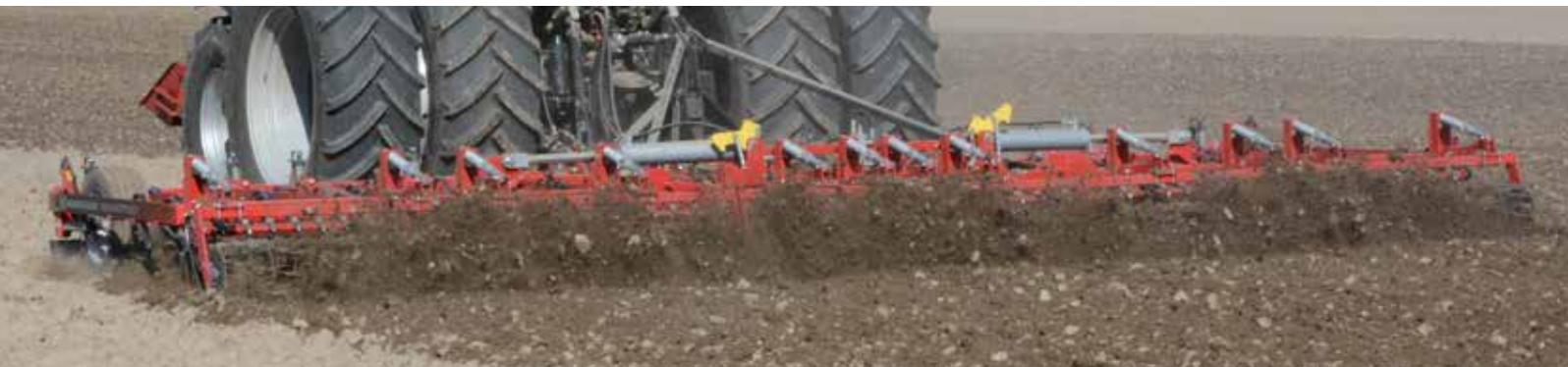
Kongskilde Vibro Master 3000 ist eine Saatbettkombination für den Dreipunktanbau, ausgerüstet mit Federzinken, in Arbeitsbreiten von 5,50 m bis 8,30 m, für Traktoren bis 250 PS.
