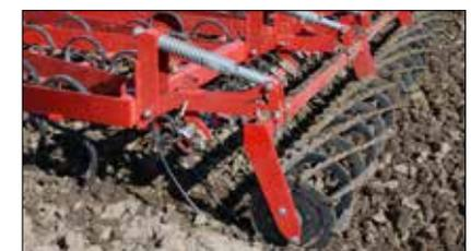
Die spezielle Anbringung der hinteren Nachlaufwerkzeuge erlaubt die Einstellung der gewünschten Rückverfestigung und die Einstellung des Arbeitswinkels.
