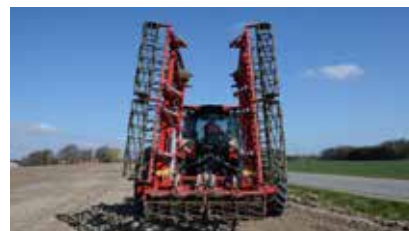
Sidefløjene foldes til lodret, så transportbredden maksimalt er 3 meter.
