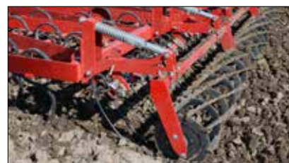
Efterharveophænget giver mulighed for individuelt indstilling af tryk og angrebsvinkel på efterharven.
