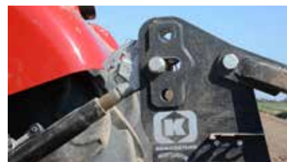
El tercer punto de enganche ayuda al cultivador a seguir el contorno del terreno en pendientes y previene sobrecargas del cultivador.
