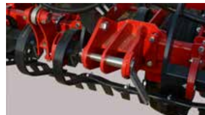
Categorías de enganche 2 y 3. Los bulones de enganche están protegidos de la rotación y del desgaste.
