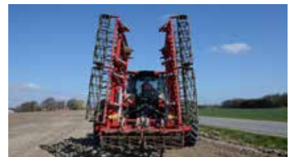
Plegado vertical con un ancho de transporte máximo de 3,0m.
