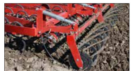
El especial sistema de sujeción permite transferir presión y cambiar el ángulo del rodillo trasero.
