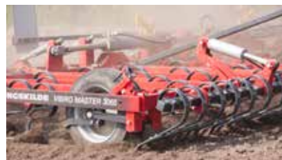
Šļūce ar iridinošām tapām vai bez tām - augšni drupina un līdzina pirms kultivatora zariem. Var ieregulēt līdzināšanas vai drupināšanas režīmā.
