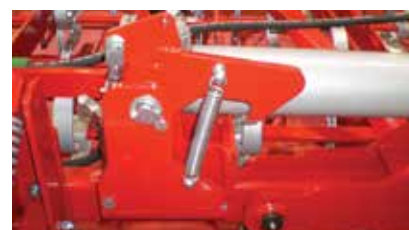
A mechanikus vagy hidraulikus szállítási reteszelés a traktorülkeből irányítható.
