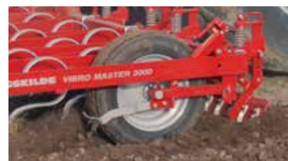
4db, nagy átmérőjű kerék gondoskodik a Vibro Masternél a pontos mélységtartásról.
