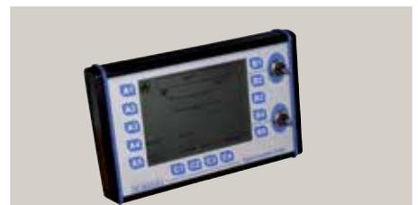
K-PLUS Bedienbox mit CAN-Bus Technologie.
