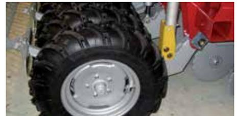
Großvolumige Fahrwerksbereifung 7.50 x 16.
