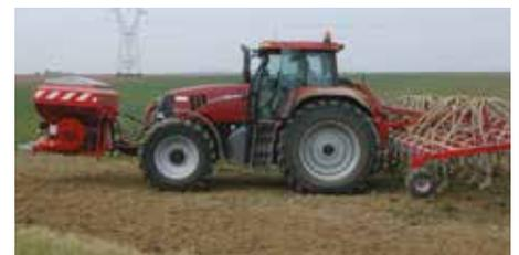
Ideale Gewichtverteilung durch Einsatz eines Frontsaatgutbehälters.
