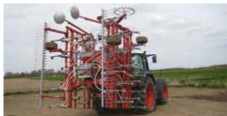
3,00 m Transportbreite durch 2-teiligen Vertikalklapprahmen.
