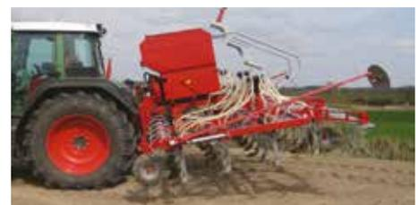
Aufgrund der kompakten Bauweise liegt der Schwerpunkt direkt hinter dem Schlepper.
