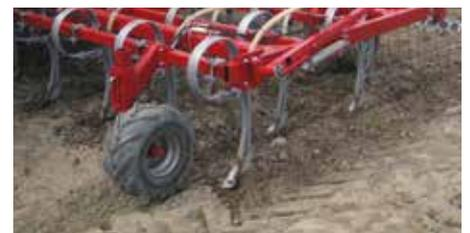
Präzise Tiefenführung über großdimensionierte Stützräder mit Stollenprofil.
