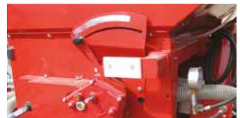
Stufenloses Vario-K Dosiergetriebe.
