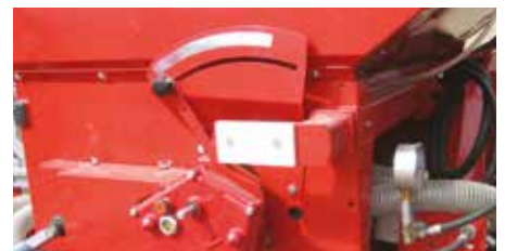
Caja de cambios mecánica Vario-K.
