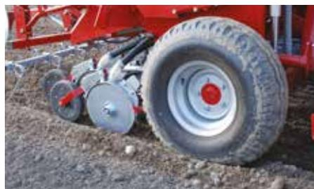
Genauer und zuverlässiger Antrieb des Dosiersystems durch große Räder.
