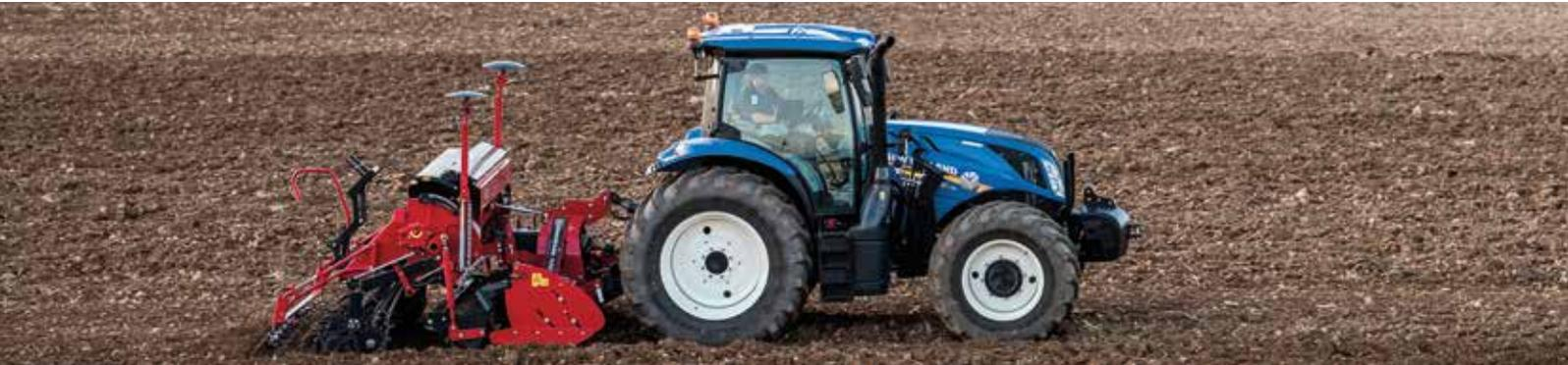
Die MasterLine eignet sich perfekt zur Kombination mit Geräten zur Saatbettbereitung. Sie ist in Arbeitsbreiten von 3 und 4 m verfügbar. Ein Sätankinhalt von über 1000 l (4m – Modell) ermöglicht eine überragende Schlagkraft und lange Feldarbeitszeiten.
