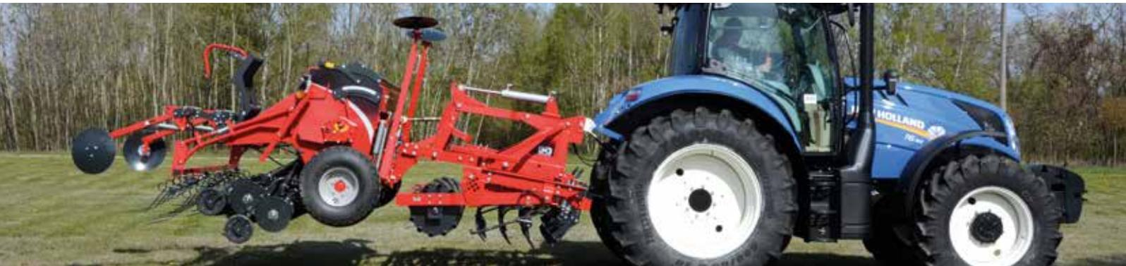
ProfiLine ist eine wirklich vielseitige und universal einsetzbare Drille für den Profi-Landwirt. Sie ist in den Arbeitsbreiten 3, 4 und 4,5 m verfügbar, bei einem Saattankvolumen von bis zu 1200 l. Dies macht sie geeignet für den Einsatz auf mittleren und großen Betrieben. Durch die Integration des Tanks in die tragenden Teile wird bei der Profiline Konstruktionsgewicht eingespart, ohne auf Stabilität und Langlebigkeit verzichten zu müssen.
