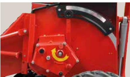
Stufenloses VARIO K Getriebe zur Einstellung der Saatmenge.
