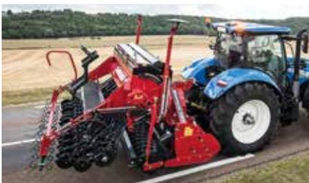
Das Gewicht der Drille wird von der Packerwalze getragen.
