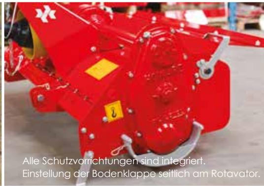
Alle Schutzvorrichtungen sind integriert. Einstellung der Bodenklappe seitlich am Rotavator.
