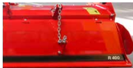
Długa, wleczona blacha odbojowa brony o specjalnym profilu.
