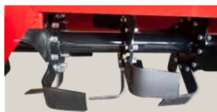
Element wału uprawowego z zębami.
