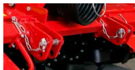
Dolne wsporniki dla ciągników z zawieszeniem kat. 1 i 2.
