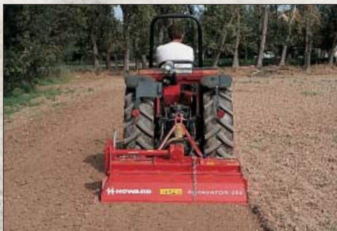
R 300B med kædetransmission. Det lange bagskjold sørger for en jævn finish.
