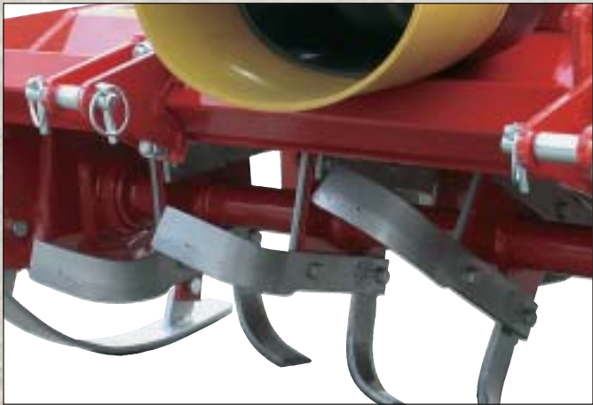
Den effektive rotor er monteret med knive (9941/2).
