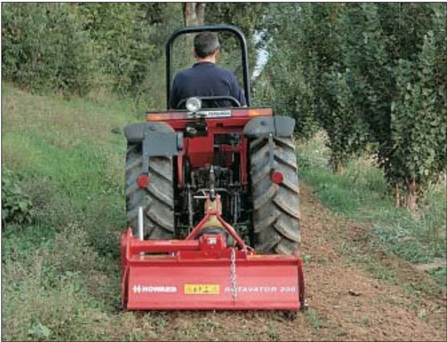
Rotavator 200-105 er specielt udviklet til smalle traktorer.
