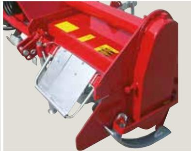
Protecciones CE ajustables, compatibles con ruedas frontales, borrahuellas, etc.
