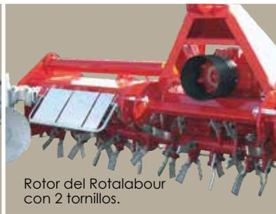
Rotor del Rotalabour con 2 tornillos.
