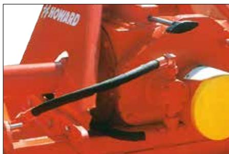
R600S-D. Equipado con cambio por palanca y refrigeración del aceite para tractores de hasta 180 HP.
