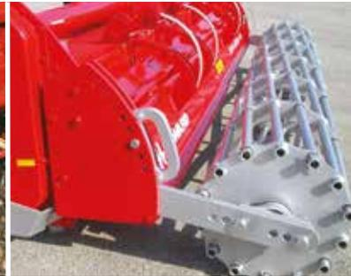
Sistema de control de profundidad compacto mediante rodillo o ruedas.
