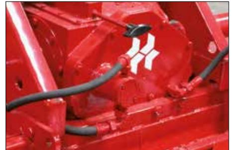
Detalle del grupo de cambio por palanca, con refrigeración por aceite.
