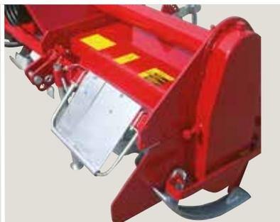
Vordere Schutzvorrichtung einstellbar. Einfache Anpassung an die Vorderräder.
