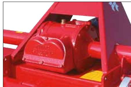
R600B-S – zuverlässiges Selectafilth-Getriebe, geeignet für Schlepper bis 140 PS.
