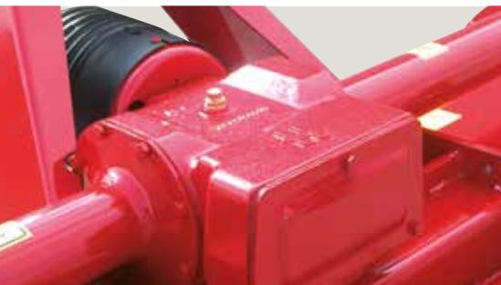
Selectatilh-Standardgetriebe (vierstufig) Einstellung der Rotordrehzahl nach gewünschter Bodenbearbeitung.
