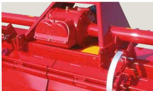
Verstärktes Selectatilh-Getriebe für eine Arbeitsbreite von 280 und 305 cm (Schlepperleistung bis 125 PS).
