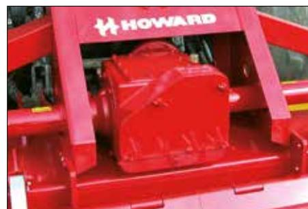
R600S-S – vierstufiges Wechselgetriebe für starke Beanspruchung, geeignet für Schlepper bis 180 PS.
