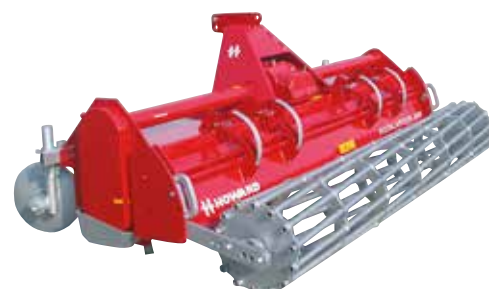
Rotavator 500S-305S avec rouleau cage et tablier rotalabour.
