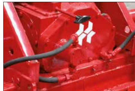
Rotavator 700X-D avec boîte à Levier et refroidissement par circulation d'huile.
