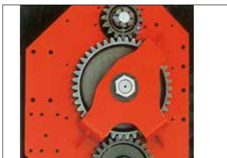
Transmission latérale à engrenage.
