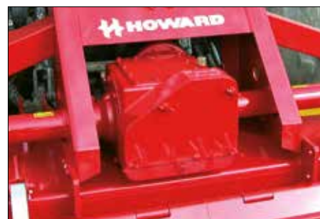
R600S-S avec boîte selectacoupe renforcée 4 vitesses conçu pour tracteur jusqu'à 180 ch.
