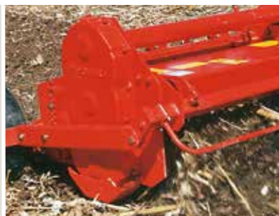
Le Rotavator est l'outil le plus efficace pour émietter le sol et incorporer les résidus.
