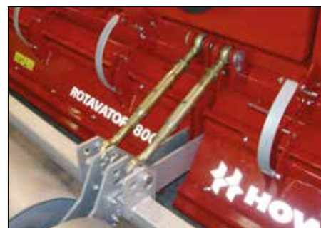
Tablier Rotalabour à déplacement vertical et réglage de profondeur.
