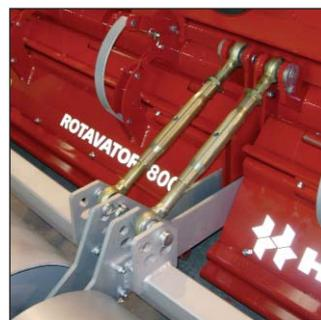
Detalle del tablier articulado que permite un montaje compacto del rodillo
