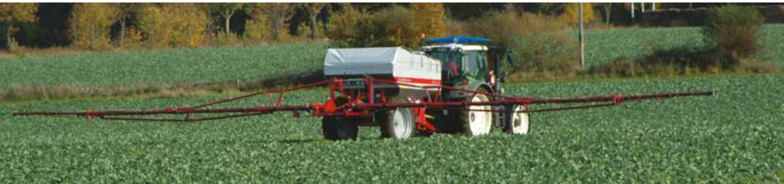
Överum Wing Jet S 4824 K-Plus Hydro under arbete i körspår. Full giva hela vägen ut till kanten, utan spill utanför.
