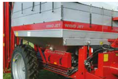
Hydraulmotorn drivs av ett dubbelverkande hydrauluttag på traktorn, och styrs noggrant av K-Plus elektroniken via en proportionalventil. Hastigheten registreras av en givare på vänster hjul.
