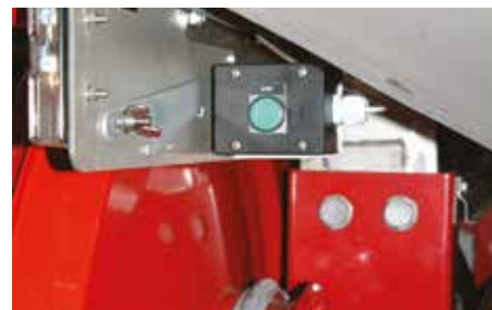
Utvändig tryckknapp för utmatningsprov. Hela kalibreringen kan göras på maskinens vänstra sida.
