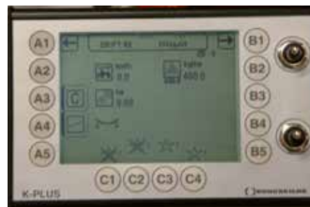
Från K-Plus monitorn kan föraren styra maskinens sektioner och utmatad giva samt få information och larm. Med kommunikationskablar kan sektionsskontroll och varierad giva styras av GPS alt. N-Sensor.
