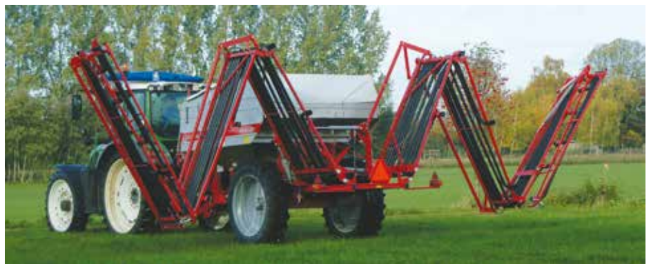
Smidig hydraulisk in- utfällning av rampen.
