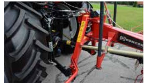
Vollbeweglicher 3-Punkt Gelenkbock sorgt für perfekte Bodenanpassung
