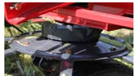
Geschlossener Getriebekasten – minimaler Wartungsaufwand
