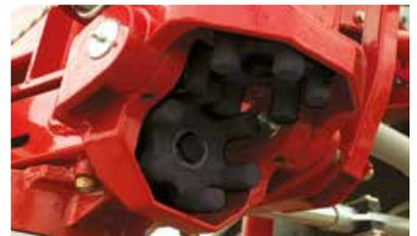
Die Finger Link Kupplungen übertragen die Kraft zwischen den Kreiseinheiten
