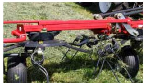
Hauptrahmen aus Kastenprofil für den intensiven Einsatz und geschlossener Antrieb
