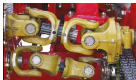
Vkládací ústrojí je poháněné prostřednictvím kloubových hřídelí
