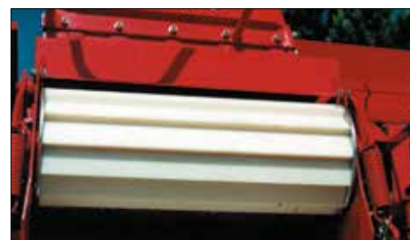
Metaldetektor. Chráněný je nejen stroj, ale také následně krměný dobytek!!!
