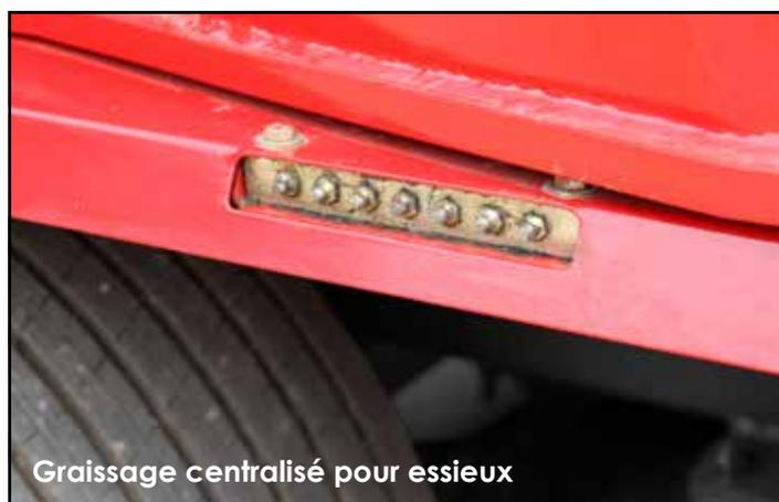
Graissage centralisé pour essieux
