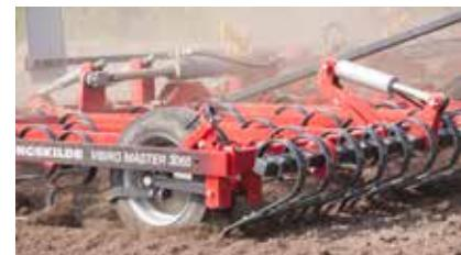
Hidraulično podešiva ravnajuća letva sa prstima za drobljenje i nivelicaciju zemljišta ispred zone kultivacije. Noseći elementi se mogu podešavati.
