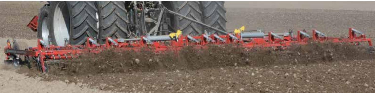
Kongskilde Vibro Master 3000 je nošeni setvospremač za predsetvenu pripremu opremljen vibrirajućim motičicama, sa radnim zahvatom od 5,5 do 8,3 m, za traktore do 250 KS.
