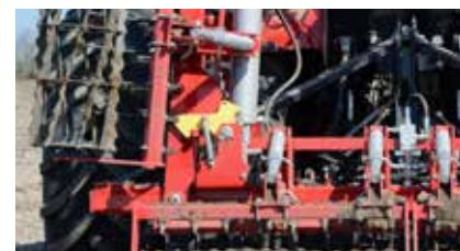
Hidrauličnim ili mehaničkim sistemom za zaključavanje se upravlja iz kabine traktora.
