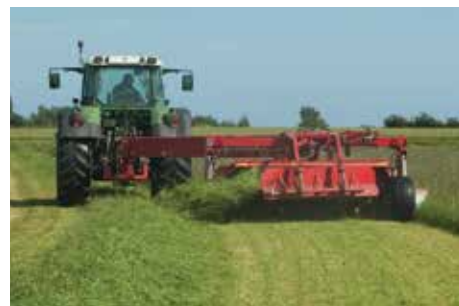
GMT L/Flex pļaujmašīnas var tikt aprīkotas ar Collector iekārtu, kura ļauj vienlaicīgi veidot 2 vālus. Tas attiecīgi var atvieglot nopļautās zāles savākšanu.
