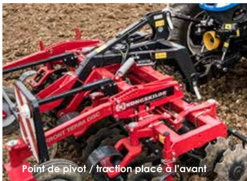
Point de pivot / traction placé à l'avant
