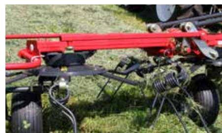
Hlavní rám krabicového profilu pro intenzivní nasazení, uzavřené převody
