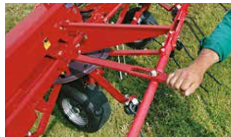
Nastavení pro práci na okraji pozemku u řady Pro
