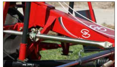
Tlumič výkyvů zklidňuje chod stroje
