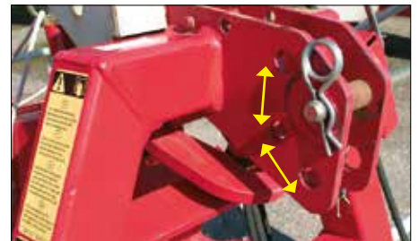
Volně pohyblivý 3bodový kloubový závěs zajišťuje optimální kopírování povrchu terénu
