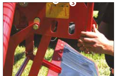
Alle middenafleg-harken hebben variabele werkbreedten. Het is mogelijk het zwaddeek te demonteren en de vrijkomende gaten te gebruiken om een nog smallere werkbreedte te verkrijgen. Dit kan van toepassing zijn wanneer in de luzerne-stand wordt gewerkt.
