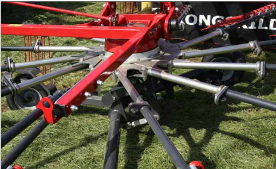
Rotorconstructie met afneembare tandamen
