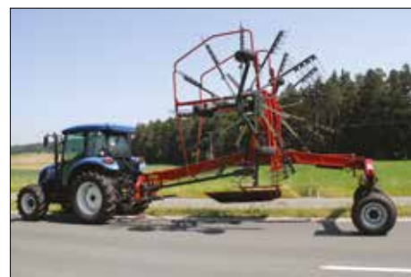
R+ 760 w położeniu transportowym. Wysokość transportowa jest poniżej 4 m.
