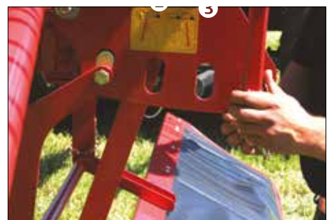
Wszystkie zgrabiarki środkowe mają regulowaną szerokość roboczą. W modelu R+ 760 można zdjąć osłonę i wykorzystać przestrzeń, aby uzyskać jeszcze mniejszą szerokość roboczą. Może to być istotne przy pracy w lucernie.
