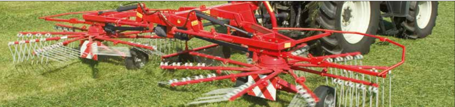
Zgrabiarka R655 DS mocowana na 3-punktowym układzie zawieszenia z pokosem środkowym.
