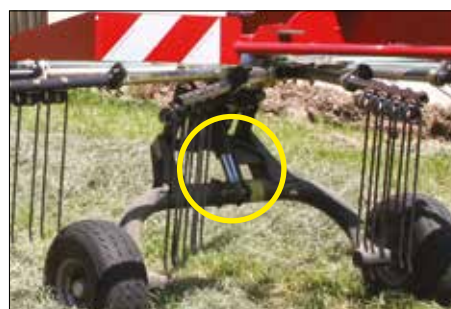
R+ 1410 SB z automatycznym kierowaniem do ostrych skrętach. Najlepsze efekty uzyskuje się przy dwóch wirnikach o nakładającym się działaniu.
