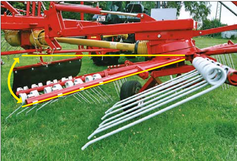
Wahliwe zawieszenie wirnika - Wirniki zawieszono na przegubie Cardana. Dzięki temu uzyskano dobre kopiowanie terenu.
