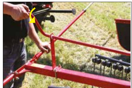
Regulacja głębokości roboczej. Bezstopniową regulację zrealizowano za pomocą korby przestawiającej.
