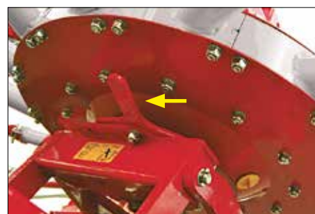
Nastavení kulísové dráhy se mění pomocí jedné páky.
