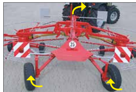
Díky progresivnímu nucenému řízení lze projíždět i nejostřejšími zatáčkami. Standardní pneu 10.0/80-12 (6PR)
