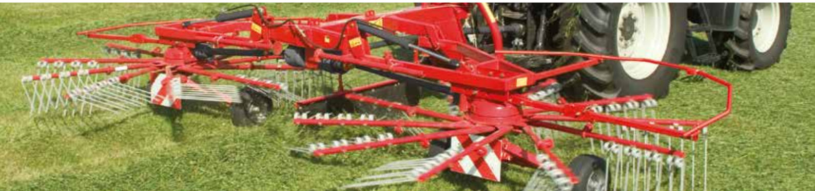
R 655 DS je nesený shrnovač shrnující do středu
