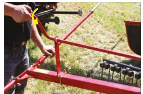
Pracovní hloubka a sklon rotorů se nastavuje pomocí kliky a čepů
