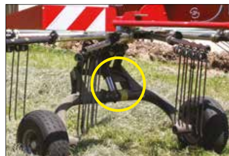
R+ 1410 SB s nuceným řízením pro ostré obraty. Nejlepších výsledků dosáhnete ve chvíli, kdy se oba rotory překrývají.
