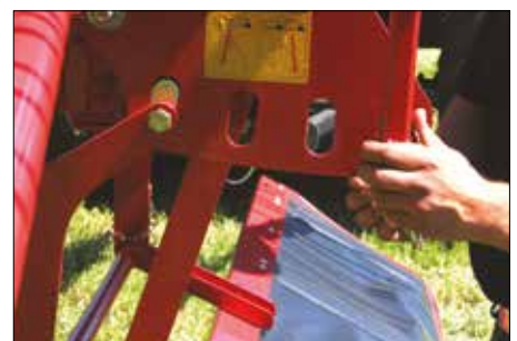
Pracovní hloubka a sklon rotorů se nastavuje pomocí kliky a čepů
