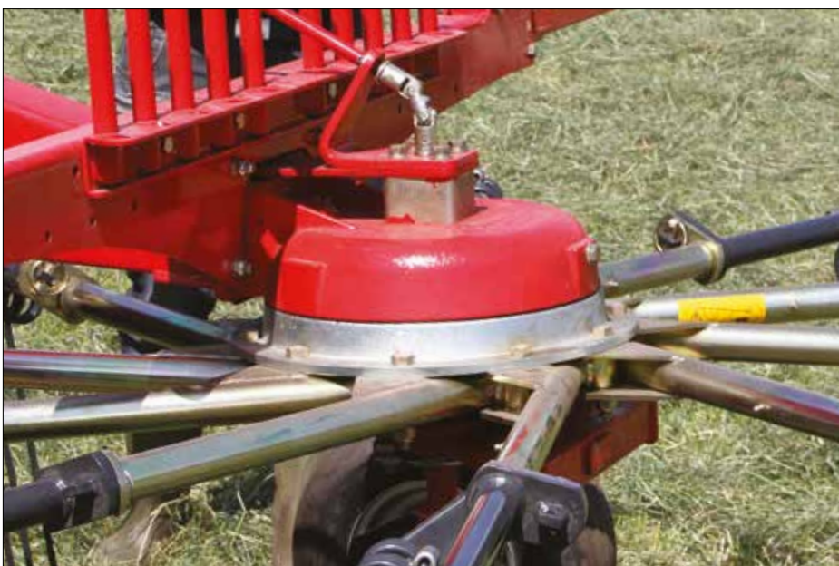
Pohyblivé zavěšení rotorů – rotory mají velkou volnost pohybu a mohou dobře kopírovat povrch terénu
