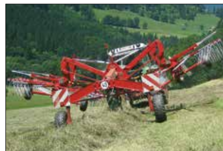
Nastavení kulísové dráhy se mění pomocí jedné páky.
