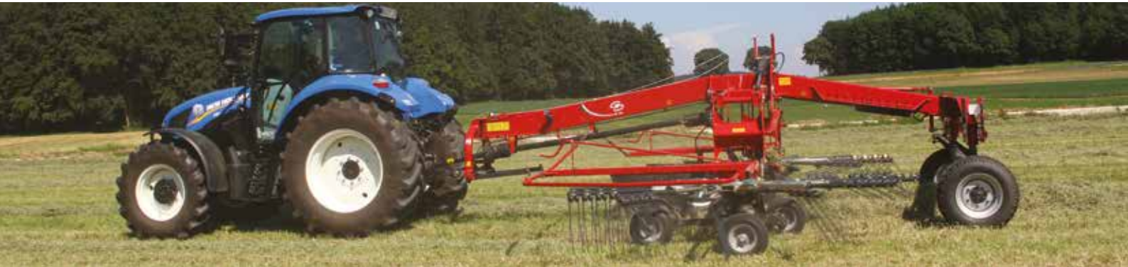
R+ 760 je tažený shrnovač shrnující do středu (pracovní záběr 6,5 - 7,6 m)
