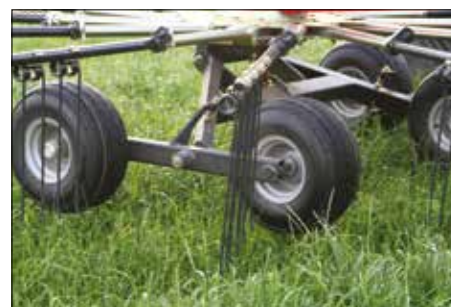
4kolový tandemový podvozek (za příplatek) zklidňuje jízdu stroje na velmi vlněném terénu
