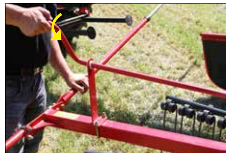
Regolazione dell'altezza di lavoro. Viene svolta semplicemente attraverso una manovella.
