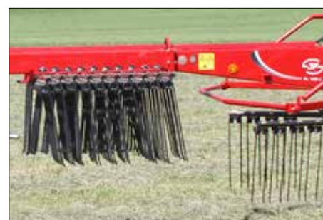
Supporto per il trasporto dei bracci portadenti Per un trasporto sicuro dei bracci portadenti e senza ostacolo alla visibilità posteriore.
