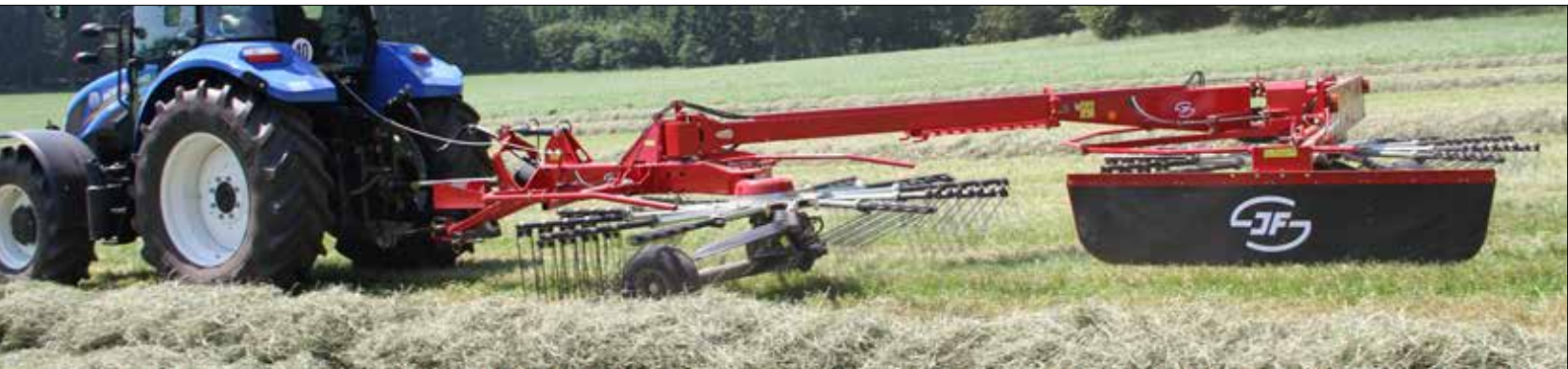
R+ 1410 S - ranghinatore ad andana laterale con telaio Multi Link
