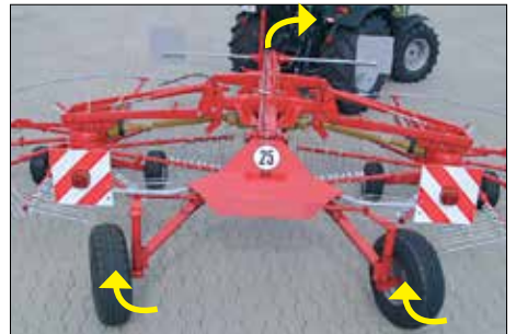
Con la sterzata attiva progressiva, anche le svolte più strette sono effettuate in sicurezza. Le gomme standard sono 10.0/80-12 (6PR).
