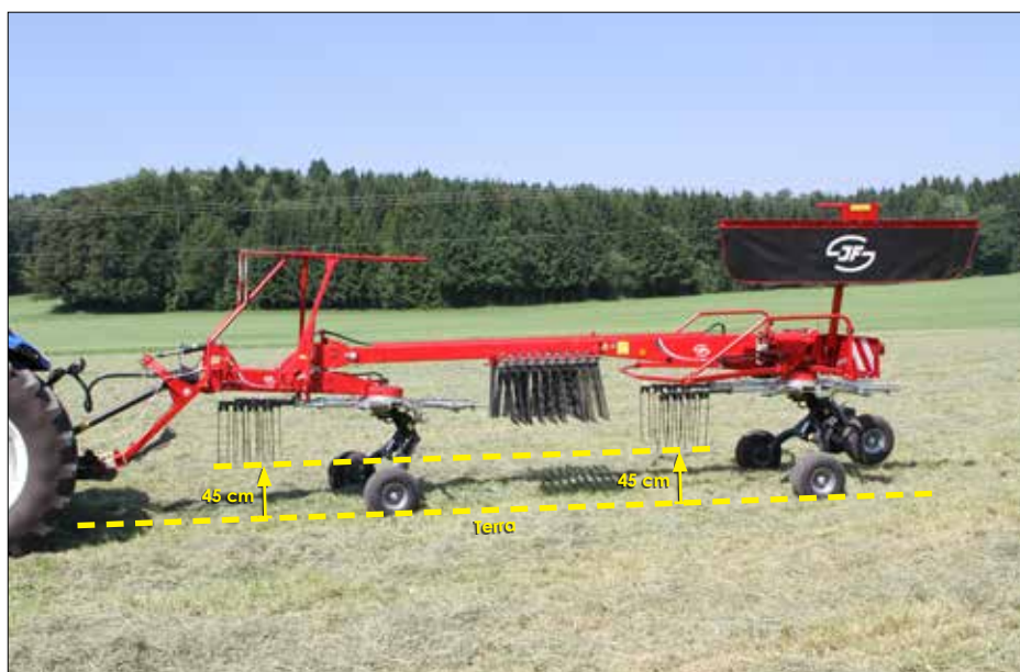
R+ 1410 S - ranghinatore ad andana laterale con telaio Multi Link
