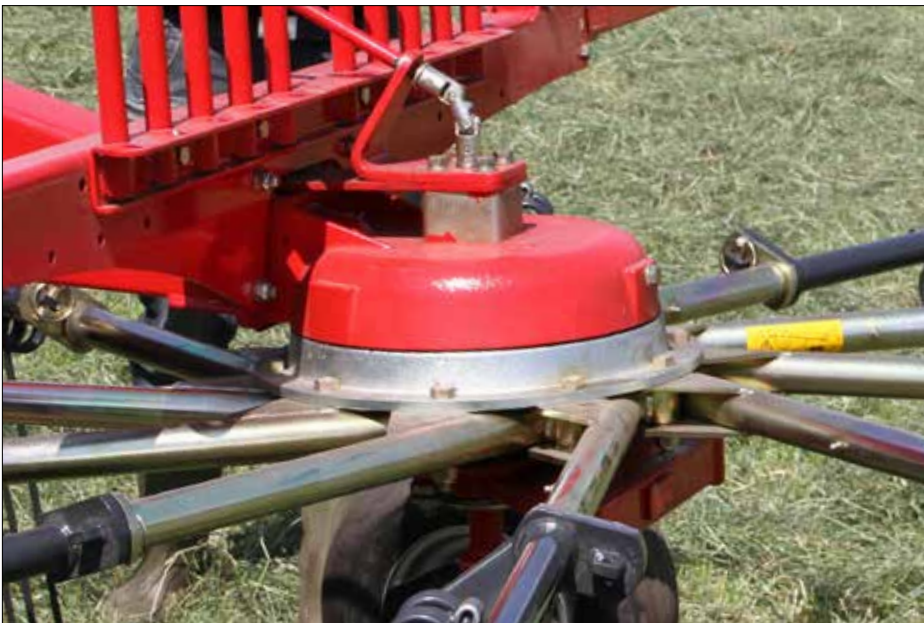
Sospensione del rotore oscillante - Questo consente una grande adattabilità al terreno.
