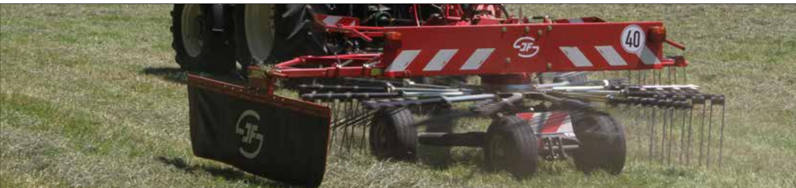
R+ 1410 SB - ranghinatore ad andana laterale con telaio Multi Link
