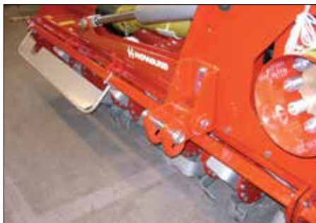
Trepunktskoppling med kat. 3 med flytande upphängning för traktorns dragstänger.
