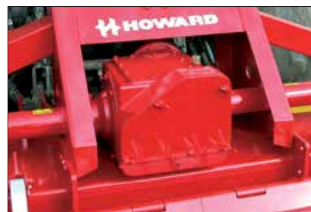
R 600 S-S. Växellåda med 4 steg för hårt arbete. För traktorer upp till 180 hk.
