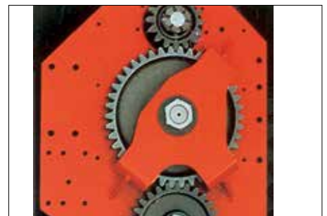
Sidotransmission med kugghjul i båda sidorna.
