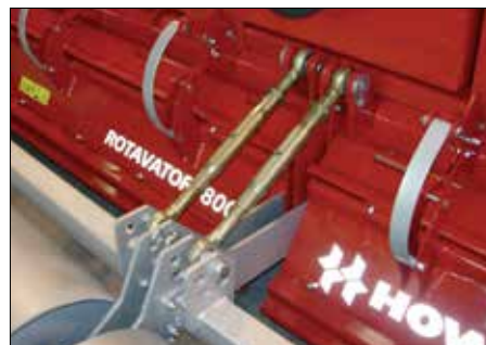
Detalj av djupreglering och den delade bakskjölden.
