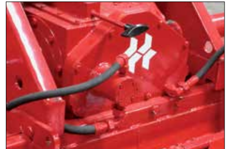
Rotavator 700 S-D växellåda. Utvändigt växelspak och olje-kylningssystem.
