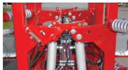
Автогидравлическая система блокировки крылья.
