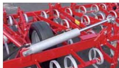
Складывание и раскладывание цилиндром двойного действия.
