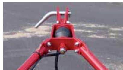
Резиновый буфер для безопасности машины и трактора.
