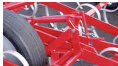
Регулировка фикс.пальцем со шкалой.
