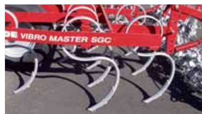
S-зуб с оборотной ультра лапой.
