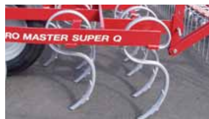
SQ-зуб с оборотной ультра лапой.
