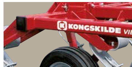
VF 2000 / 4200 / 4300 / 4000 Wytrzymała rama o przekroju zamkniętym.
