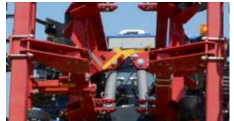
Automatinė hidr. sparnų užrakto sistema.
