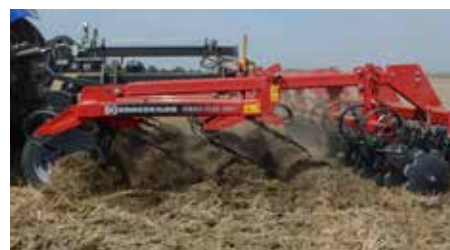
4 zaru rindas nodrošina labu sajaukšanos augu atlieku un augsnes sajaukšanos.
