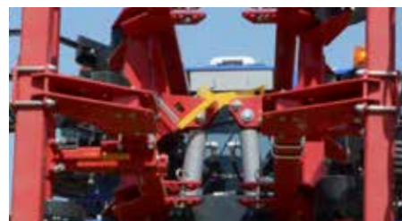
Automātiski sānu sekciju bloķēšanas mehānisms.
