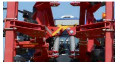
Automaatne hüdrailline tööseksioonide lukustus transpordiasendisse.
