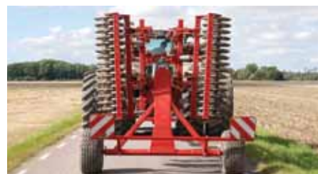
Transportwielen zorgen voor veilig wegtransport. DF 5000 HT
