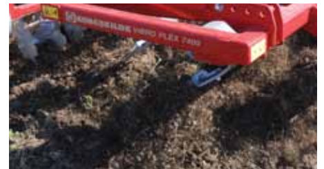
4 rijen tanden zorgen voor een intensieve menging van de grond en gewasresten.
