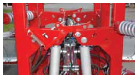
Hydr. transport blokkering van de zijvleugels.
