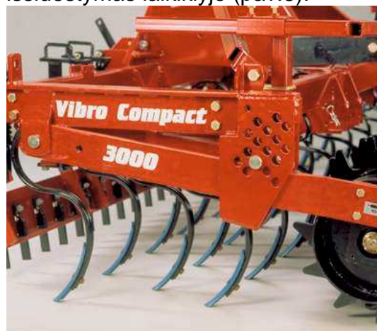
Pav. 8. Ant akėčių peties esančių angų sistema, skirta dantų darbo gyliui reguliuoti
