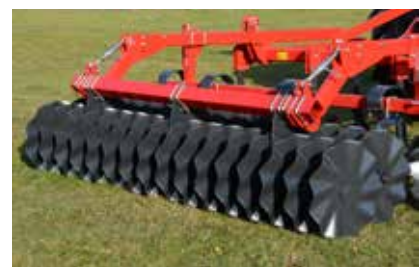
Podwójny wał tnący Cutter Roller.
