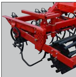
Regulacja głębokości pracy poprzez system sworzni.
