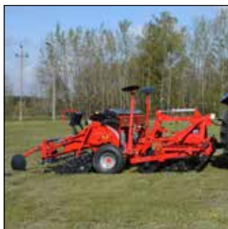
brona + siewnik zbożowy połączony za pomocą sprzęgu hydraulicznego – pozycja robocza.
