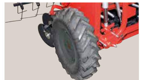
Tractor profiel aandrijf wiel incl. schraper.
