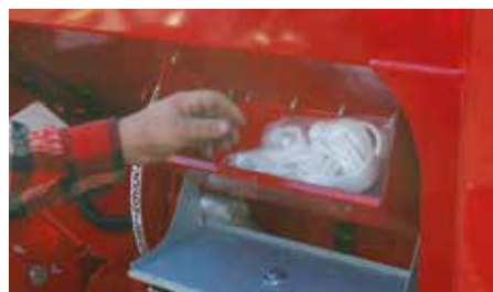
Geïntegreerde opbergbak voor gereedschap, inzetklauwen voor fijnzaad etc.
