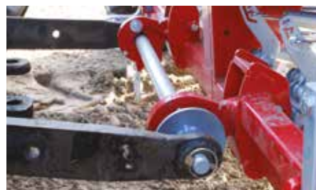
Snelkoppeling voor eenvoudig en veilig aan- en afkoppelen.
