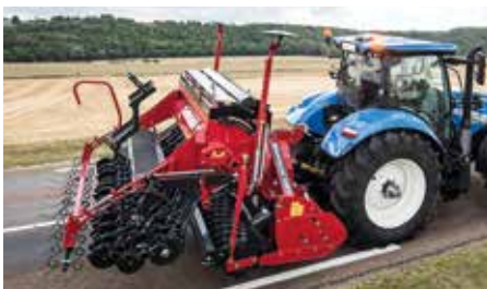
Het gewicht van de zaaimachine wordt gedragen door de rol van het opbouw werktuig.
