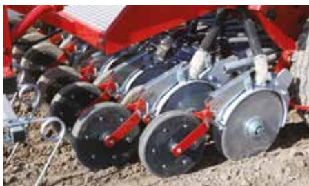
Dubbel schijfkouter (DR) in combinatie met rubber aandrukwielen.
