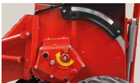
Vario-K belaipsnė išsėjimo normos nustatymo greičių dėžė.
