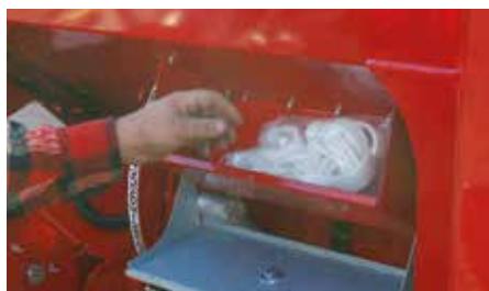
Integruota daiktadėžė, įrankių, atsarginių dalių ir t.t. laikymui.
